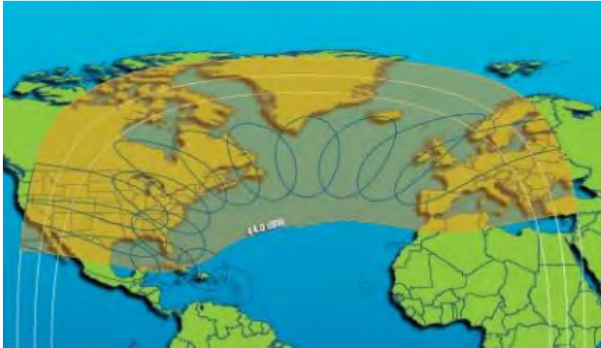
Рис. 110. ЭИИМ (дБ·Вт) в рабочих зонах (многолучевая) ИСЗ INTELSAT-32e (43,1° з.д.) в Ku-диапазоне частот
