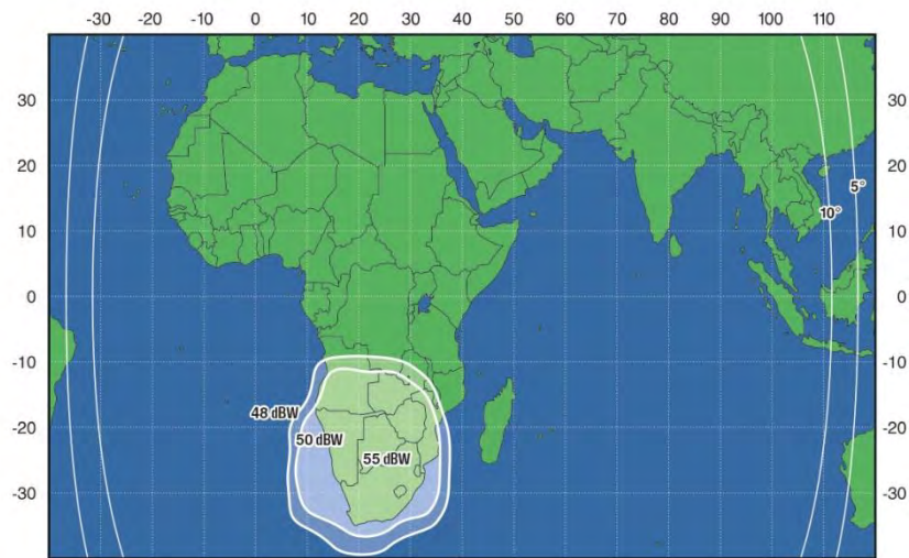
Рис. 43. ЭИИМ (дБ·Вт) в рабочей зоне (2 вариант перенацеливаемого луча) ИСЗ ЭКСПРЕСС-АМ7 (40° в.д.) в Ku-диапазоне частот
