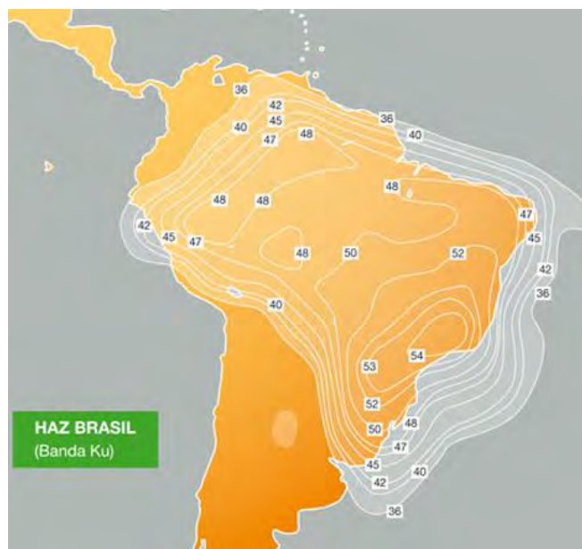
Рис. 30. ЭИИМ (дБ-Вт) в рабочей зоне (Бразилия) ИСЗ AMAZONAS-3 (61° з.д.) в Ku-диапазоне частот
