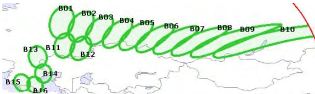
Рис. 88. Рабочие зоны ИСЗ ЯМАЛ-601 (49° в.д.) в Ka-диапазоне частот
