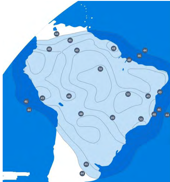
Рис. 16. ЭИИМ (дБ-Вт) в рабочих зонах (на Южную Америку) ИСЗ HISPASAT-36W-1 (36° з.д.) в Ku-диапазоне частот
