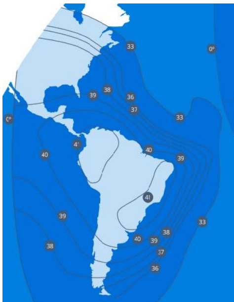
Рис. 21. ЭИИМ (дБ·Вт) в рабочих зонах ИСЗ HISPASAT-30W-6 (-1F) (30° з.д.) в С-диапазоне частот
