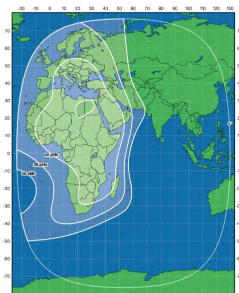
Рис. 28. ЭИИМ (дБВт) в рабочей зоне (африканский луч) ИСЗ ЭКСПРЕСС-АМ6 (53° в.д.) в С-диапазоне частот
