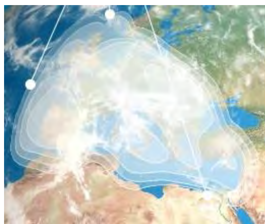
Рис. 1. ЭИИМ (дБ·Вт) в рабочих зонах (а – 1-й и б – 2-й фиксированные лучи, в – перенацеливаемые лучи) ИСЗ HELLAS-SAT-2 (39° в.д.) в Ku-диапазоне частот
