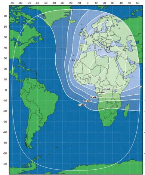
Рис. 45. ЭИИМ (дБ-Вт) в рабочей зоне (африканский луч) ИСЗ ЭКСПРЕСС-АМ8 (14° з.д.) в С-диапазоне частот
