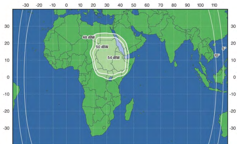
Рис. 42. ЭИИМ (дБВт) в рабочей зоне (1 вариант перенацеливаемого луча) ИСЗ ЭКСПРЕСС-АМ7 (40° в.д.) в Ku-диапазоне частот
