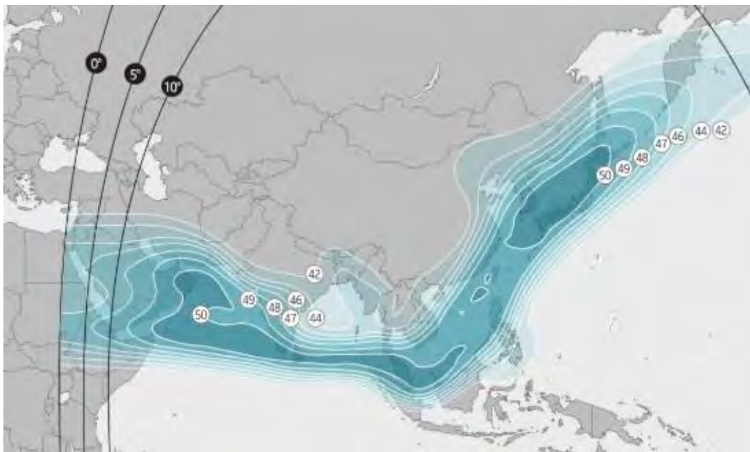
Рис. 12. ЭИИМ (дБ-Вт) в рабочих зонах (морские абоненты) ИСЗ KOREASAT-5A (113° в.д.) в Ku-диапазоне частот
