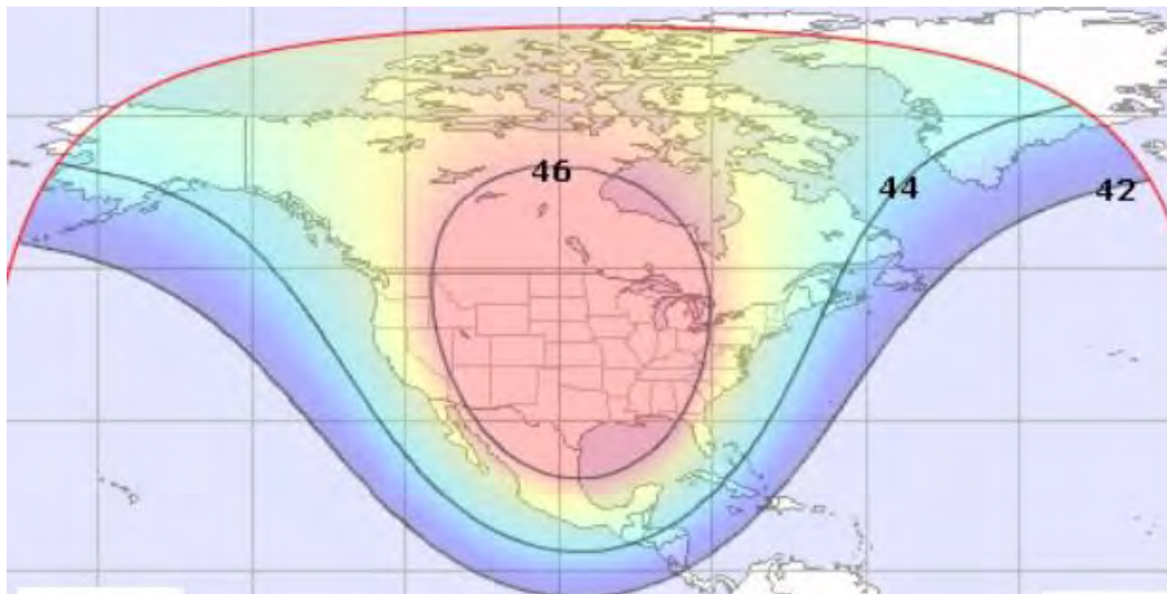
Рис. 140. ЭИИМ (дБ·Вт) в рабочих зонах (Мексика, США и Канада) ИСЗ GALAXY-35 (95° з.д.) в Ka-диапазоне частот
