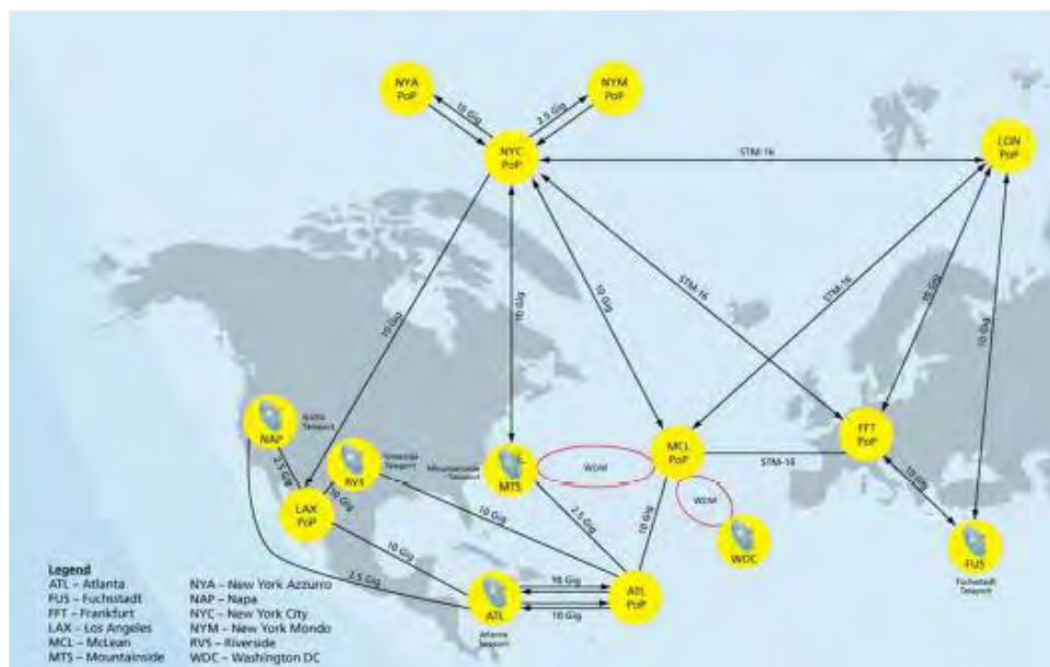
Рис. 1. Состав системы компании IntelSat (а), зоны радиовидимости станций приема телеметрии и передачи команд телепортов (б) и состав и характеристики наземных оптоволоконных линий (в) системы компании IntelSat
