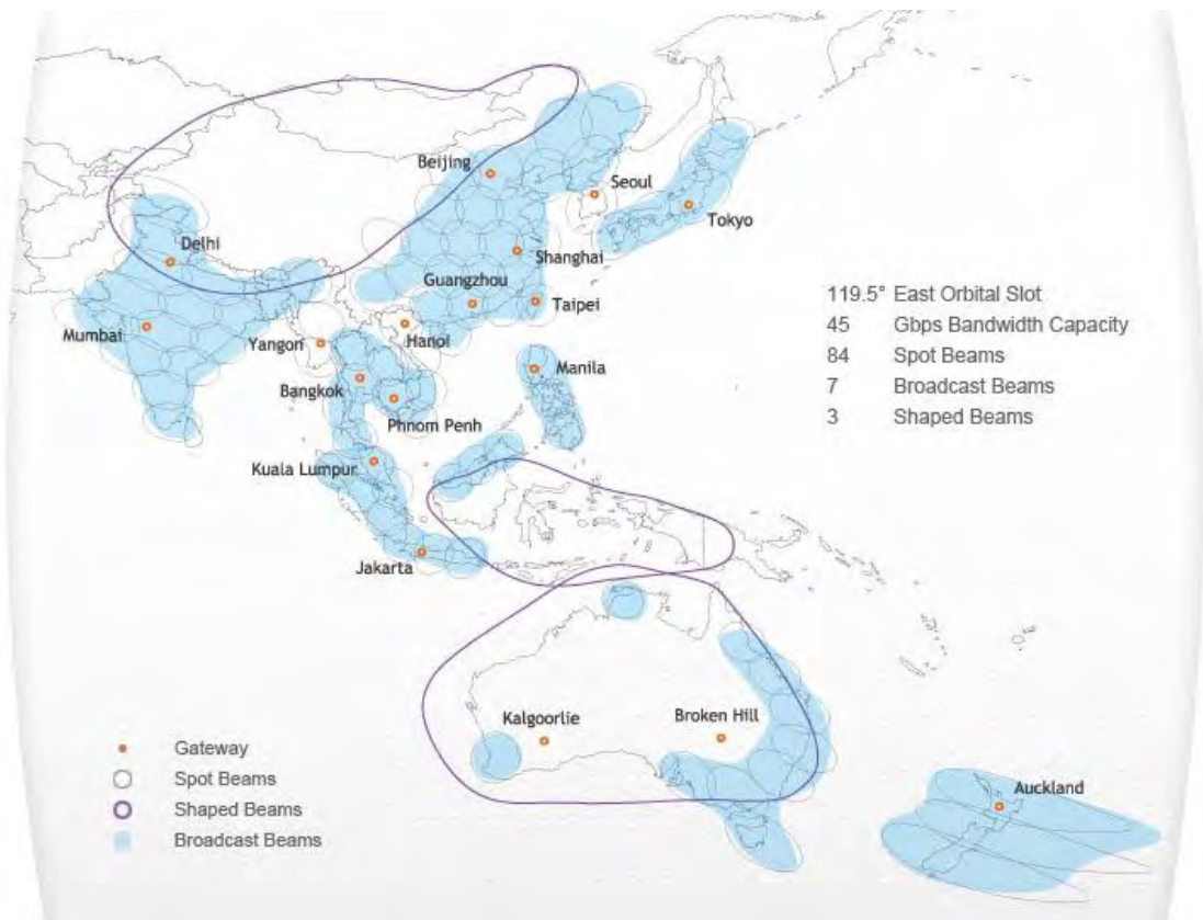
Рис. 31. Рабочие зоны ИСЗ IPSTAR-1 (THAICOM-4) (119,5° в.д.) в Ku-диапазоне частот
