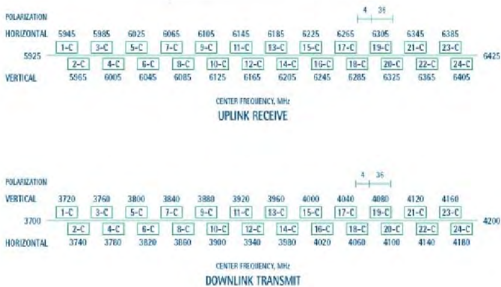
Рис. 48. Частотный план ретрансляторов С-диапазона частот ИСЗ GALAXY-13
