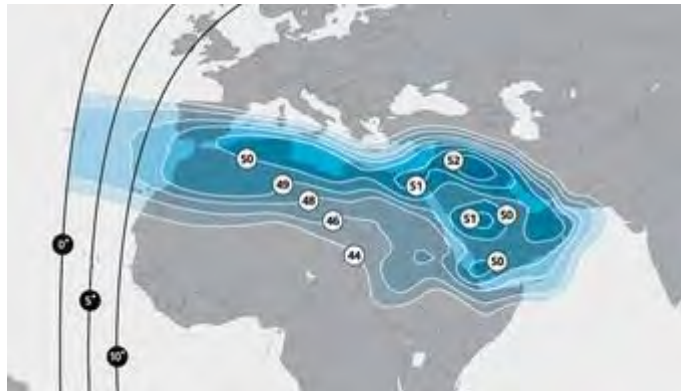
Рис. 105. ЭИИМ (дБ Вт) в рабочих зонах (Ближний Восток и Северная Африка) ИСЗ MONACOSAT (52° в.д.) в Ku-диапазоне частот
