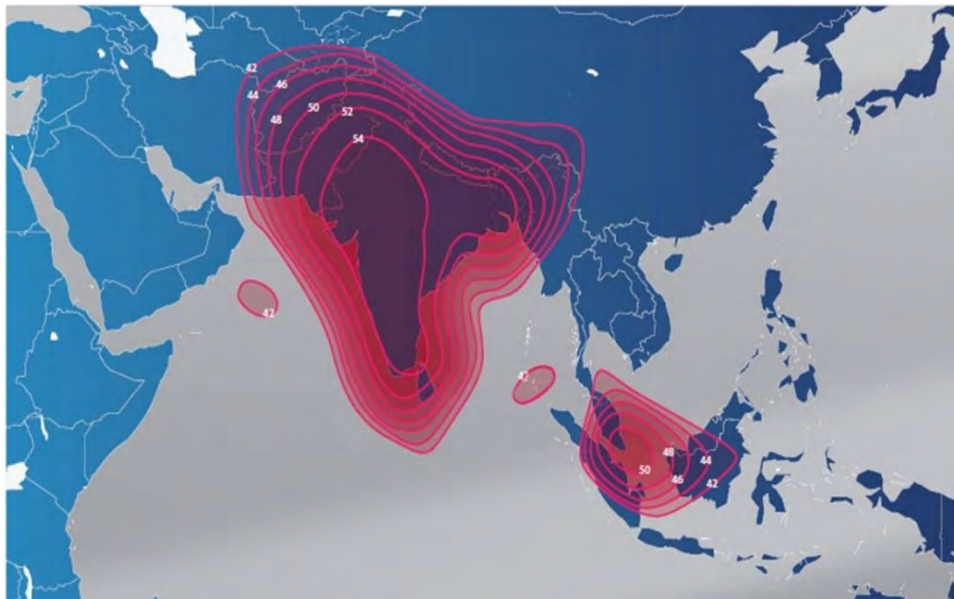
Рис. 39. ЭИИМ (дБ·Вт) в рабочих зонах (Индия и часть Индонезии) ИСЗ ST-2 (88° в.д.) в Ku-диапазоне частот
