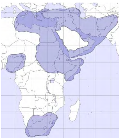
Рис. 45. Рабочие зоны (Турция и Африка) ИСЗ TURKSAT-5B (42° в.д.) в Ка-диапазоне частот
