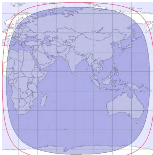
Рис. 25. Рабочие зоны ИСЗ INMARSAT-6F1 (84° в.д.) в Ка-диапазоне частот
