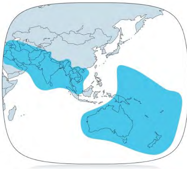
Рис. 34. Рабочие зоны ИСЗ THAICOM-7 (120° в.д.) в С-диапазоне частот
