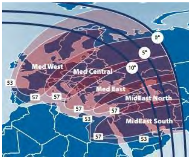
Рис. 51. ЭИИМ (дБ·Вт) в рабочих зонах (восемь узких лучей) ИСЗ TELSTAR-12 VANTAGE (15° з.д.) в Ки-диапазоне частот
