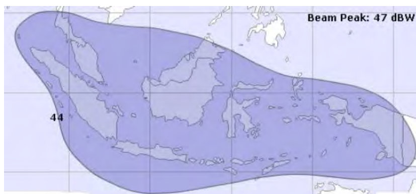
Рис. 52. ЭИИМ (дБ·Вт) в рабочей зоне ИСЗ SES-7 (108,2° в.д.) в S-диапазоне частот
