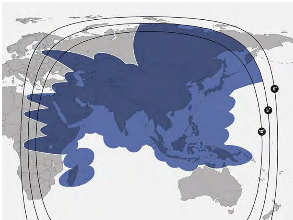
Рис. 138. ЭИИМ (дБ Вт) в рабочих зонах (узкие лучи на: а – северно-восточную Азию, б – Сибирь и Дальний Восток РФ, в – южную Азию, г – юго-восточную Азию, д – западную Африку, Ближний Восток и Центральную Азию и е – суммарная картина узких лучей многолучевой антенной системы) ИСЗ SES-12 (95° в.д.) в Ku-диапазоне частот
