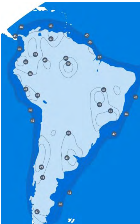
Рис. 9. ЭИИМ (дБ-Вт) в рабочих зонах (на Южную Америку) ИСЗ HISPASAT-74W-1 (AMAZONAS-4 (-4A)) (74° з.д.) в Ku-диапазоне частот
