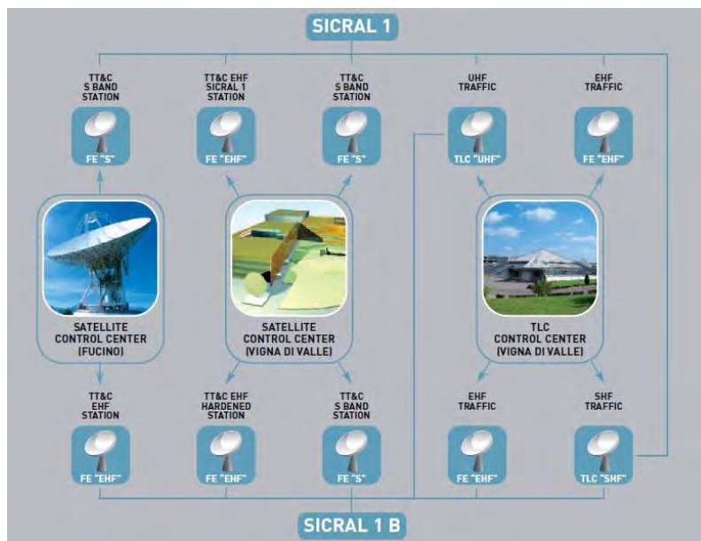
Рис. 5. Состав наземного сегмента системы Sicral-1
