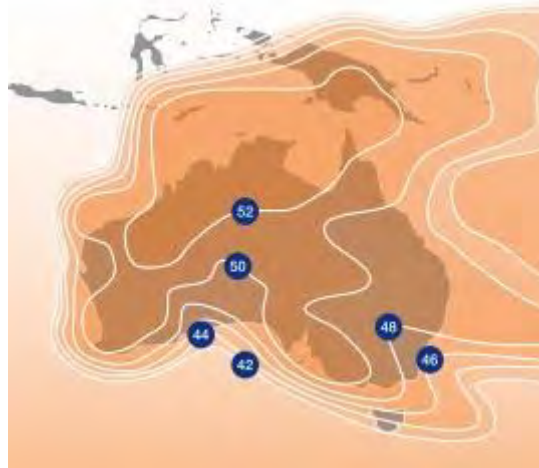
Рис. 11. ЭИИМ (дБ·Вт) в рабочих зонах (а – индийский, б – индонезийский, в – малазийский и г – австралийский лучи) ИСЗ MEASAT-3B (91,5° в.д.) в Ku- диапазоне частот
