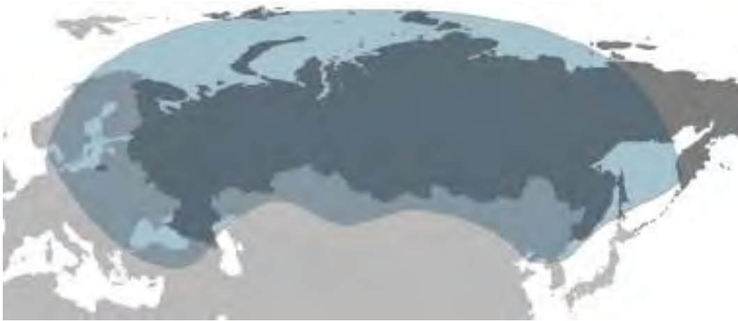
Рис. 91. Планирующиеся рабочие зоны ИСЗ ЯМАЛ-501 (82° в.д.) в Ku-диапазоне частот
