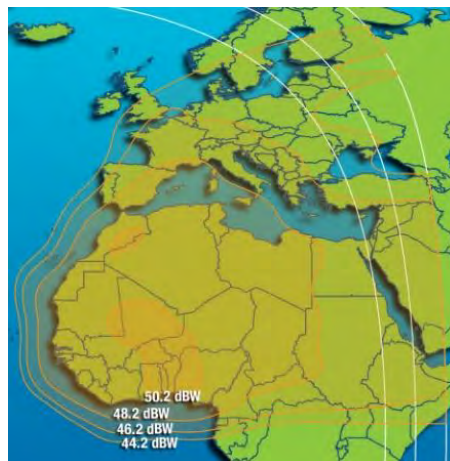
Рис. 112. ЭИИМ (дБ·Вт) в рабочих зонах (Африка и Европа) ИСЗ INTELSAT-35e (34,5° з.д.) в Ku-диапазоне частот
