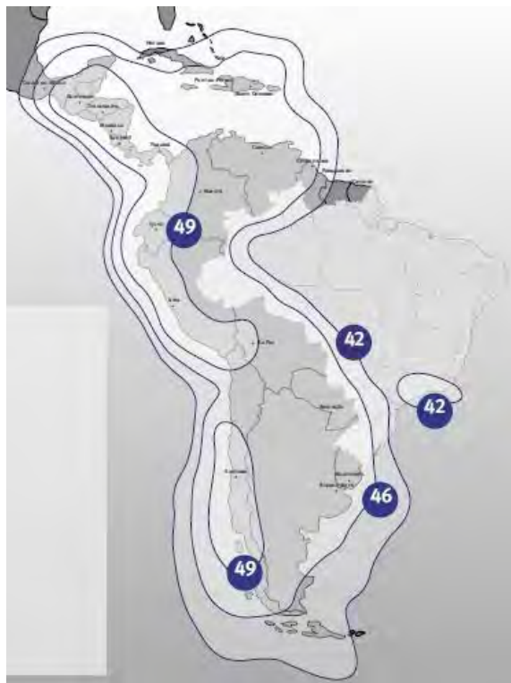
Рис. 12. ЭИИМ (дБ·Вт) в рабочих зонах (Латинская Америка) ИСЗ HISPASAT-70W-1 (STAR ONE-C4) (70° з.д.) в Ku-диапазоне частот
