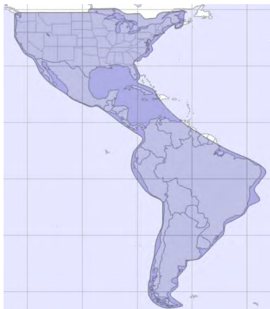
Рис. 103. Планируемая рабочая зона ИСЗ ECHOSTAR-24 (JUPITER-3) (95° з.д.) в Ka-диапазоне частот
