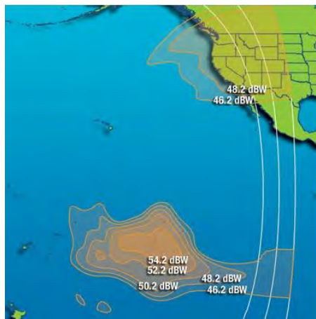
Рис. 83. ЭИИМ (дБ·Вт) в рабочих зонах (а – австралийский луч, б – полинезийский луч) ИСЗ INTELSAT-18 (180° в.д.) в Ku-диапазоне частот
