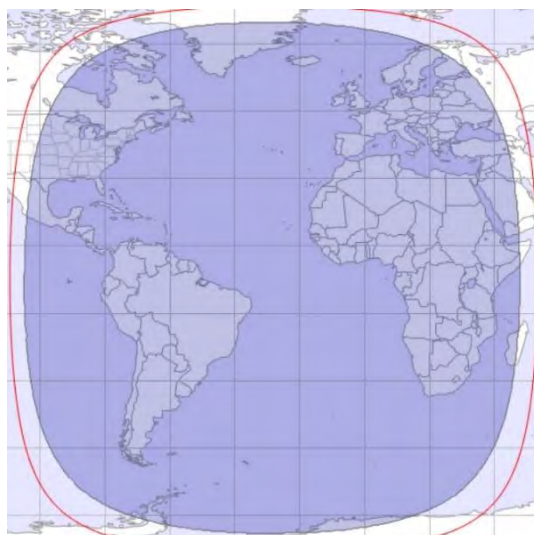
Рис. 26. Планирующиеся рабочие зоны ИСЗ INMARSAT-6F2 (28° з.д.) в Ка-диапазоне частот
