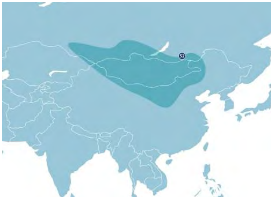
Рис. 6. Рабочие зоны (а) и ЭИИМ (дБ·Вт) в рабочих зонах ретрансляторов ИСЗ ASIAsAT-9 (122,2° в.д.) в С- (б) и Ku- (в – восточная Азия, г – Мьянма, д – Индонезия, е – Австралия, ж - Монголия) диапазонах частот
