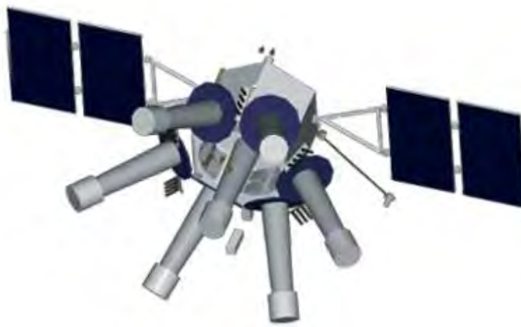
Рис. 4. Конструктивная схема ИСЗ серии ГОНЕЦ-М1
