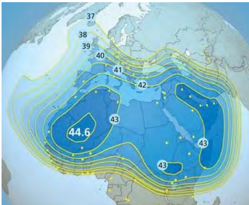
Рис. 37. Планирующаяся ЭИИМ (дБ Вт) в рабочих зонах ИСЗ ARABSAT-6E (34,5° в.д.) в стандартном С-диапазоне частот
