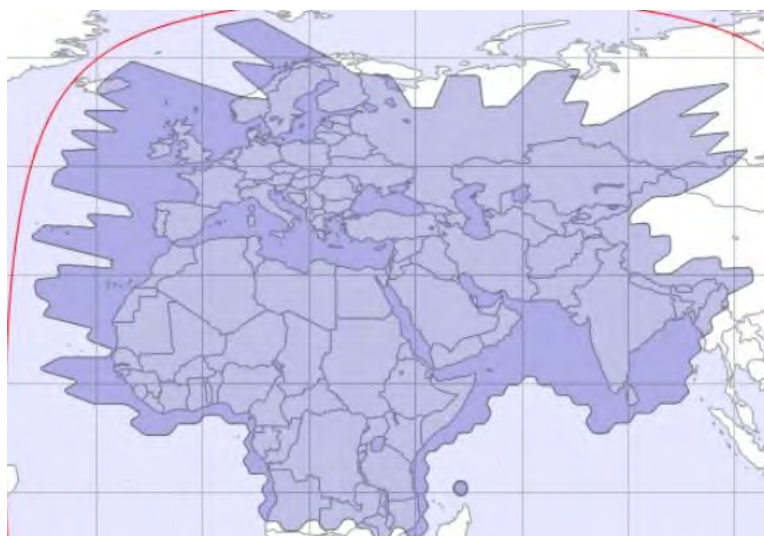
Рис. 43. Рабочие зоны ИСЗ THURAYA-2 (44° в.д.) в L-диапазоне частот
