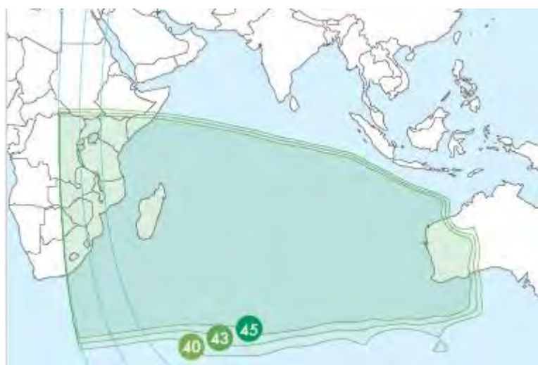
Рис. 18. ЭИИМ (дБ-Вт) в рабочих зонах ИСЗ JCSAT-110A (-15) (110° в.д.) в Ки-диапазоне частот
