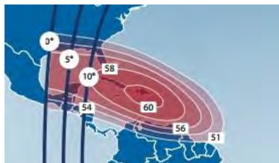
Рис. 50. ЭИИМ (дБ·Вт) в рабочих зонах (четыре зональных луча) ИСЗ TELSTAR-12 VANTAGE (15° з.д.) в Ки-диапазоне частот
