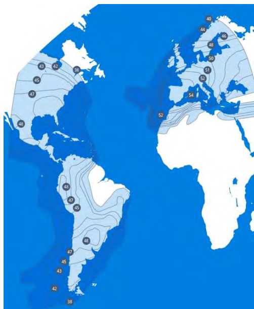
Рис. 2. Рабочие зоны и ЭИИМ (дБ-Вт) в рабочих зонах ИСЗ HISPASAT-30W-4 (-1D) (30° з.д.) в Ku-диапазоне частот
