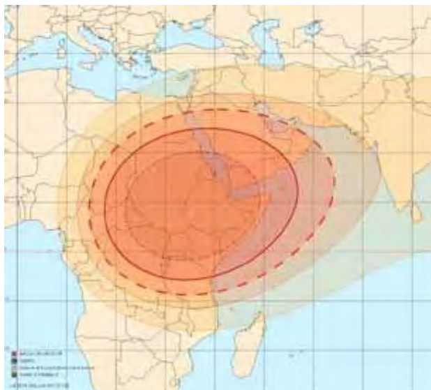
Рис. 22. Рабочие зоны на передачу (Центральная и Западная Африка) ИСЗ серии SKYNET-5 в X-диапазоне частот
