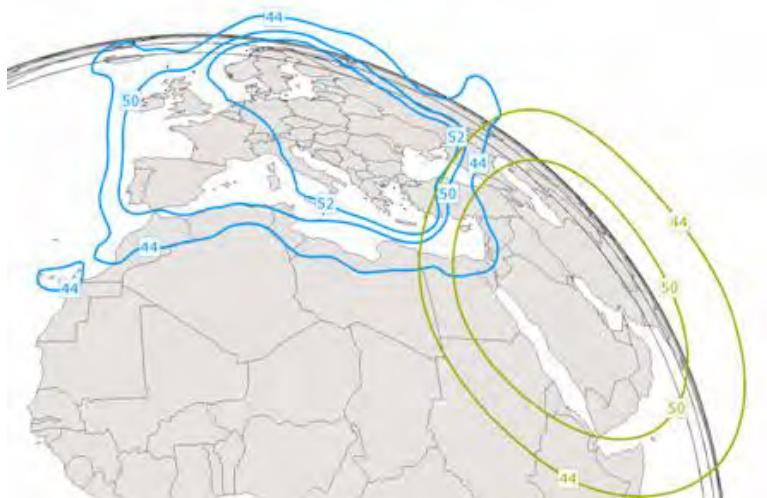
Рис. 5. ЭИИМ (дБ·Вт) в рабочих зонах (перенацеливаемый луч) ИСЗ THOR-5 (0,7° з.д.) в Ku-диапазоне частот
