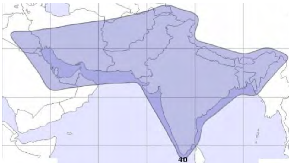
Рис. 3. Рабочая зона ИСЗ GSAT-10 (83° в.д.) в С-диапазоне частот
