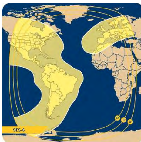
Рис. 82. Рабочие зоны ИСЗ SES-6 (40,5° з.д.) в C-диапазоне частот
