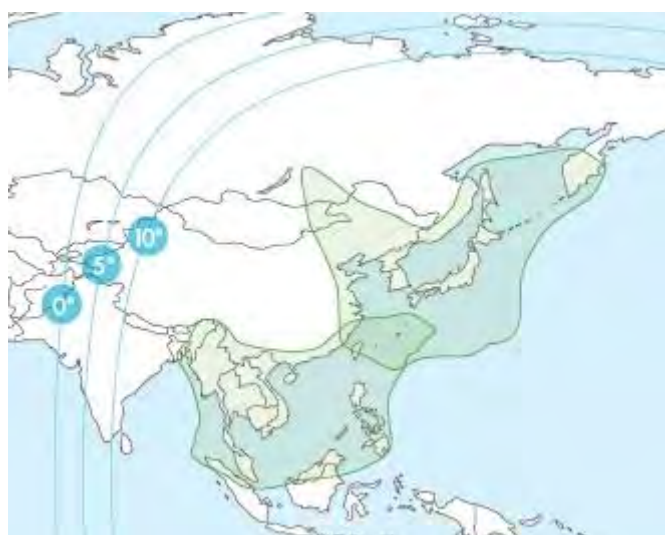
Рис. 25. Рабочие зоны ИСЗ JCSAT-18 (150° в.д.) в Ku-диапазоне частот
