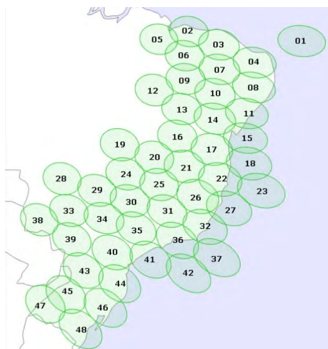
Рис. 1. Рабочая зона ИСЗ системы Siscomis в X-диапазоне частот
