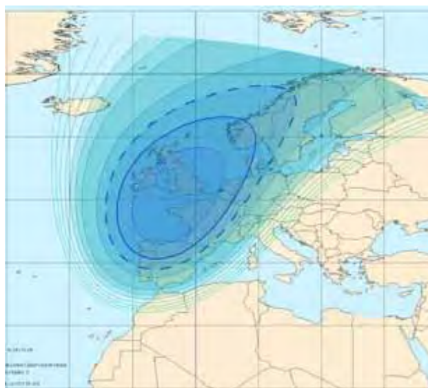
Рис. 15. Рабочие зоны на прием (Соединенное Королевство) ИСЗ серии SKYNET-5 в X-диапазоне частот
