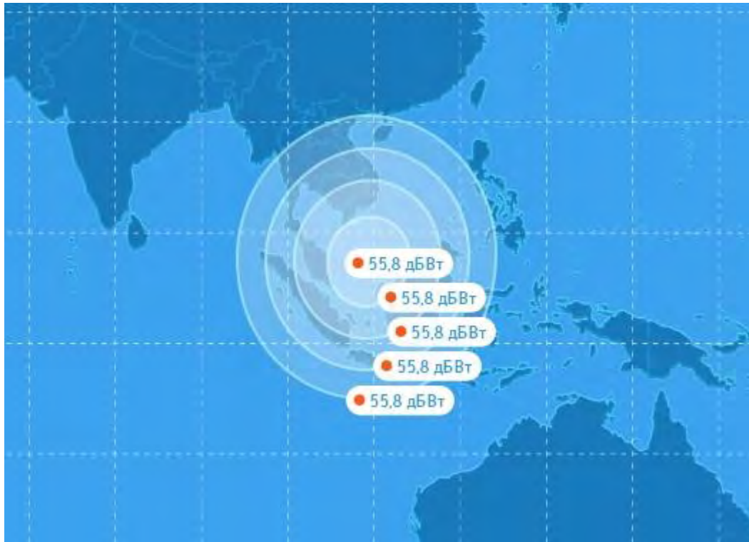
Рис. 5. ЭИИМ (дБВт) в рабочей зоне (перенацеливаемый луч) ИСЗ ЭКСПРЕСС-АМЗ (103° в.д.) в Ku-диапазоне частот
