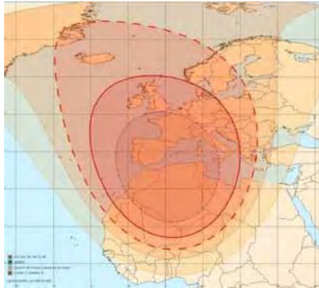
Рис. 26. Рабочие зоны на передачу (Северная Африка и Западная Европа) ИСЗ серии SKYNET-5 в X-диапазоне частот
