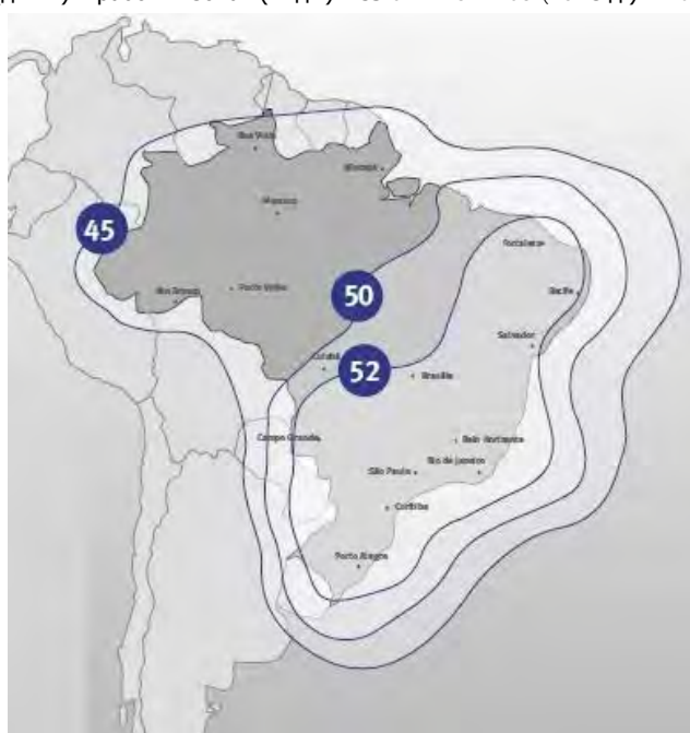
Рис. 18. ЭИИМ (дБ·Вт) в рабочих зонах (Бразилия) ИСЗ STAR ONE-C3 (75° з.д.) в Ku-диапазоне частот
