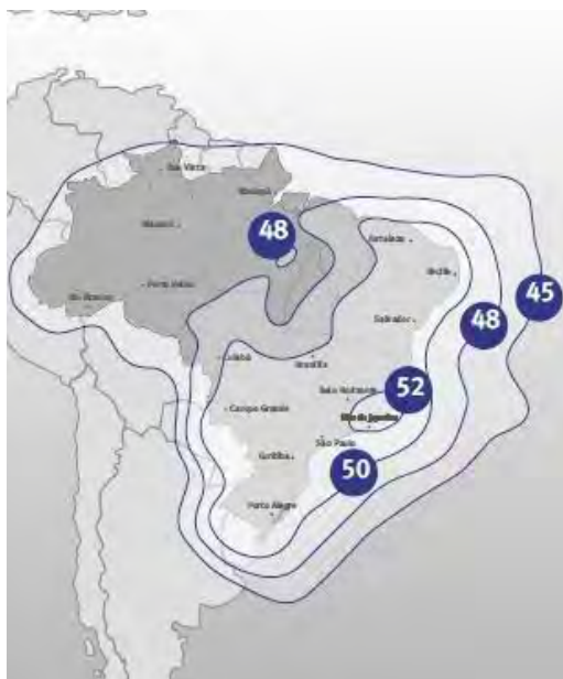
Рис. 11. ЭИИМ (дБ·Вт) в рабочих зонах (Бразилия) ИСЗ HISPASAT-70W-1 (STAR ONE-C4) (70° з.д.) в Ки-диапазоне частот
