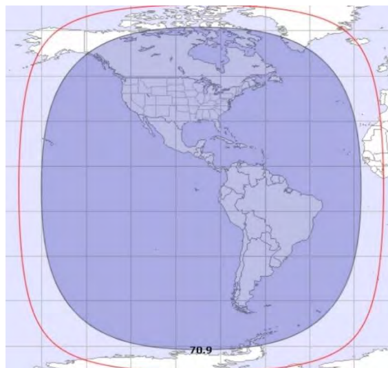
Рис. 124. ЭИИМ (дБ·Вт) в рабочих зонах (сведенные воедино узкие лучи для абонентов (а) и шлюзовых станций (б)) ИСЗ VIASAT-3.1 (88,9° з.д.) в Ка-диапазоне частот
