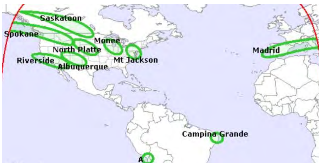
Рис. 56. Рабочие зоны шлюзовых станций ИСЗ TELSTAR-19 VANTAGE (63° з.д.) в Ka-диапазоне частот
