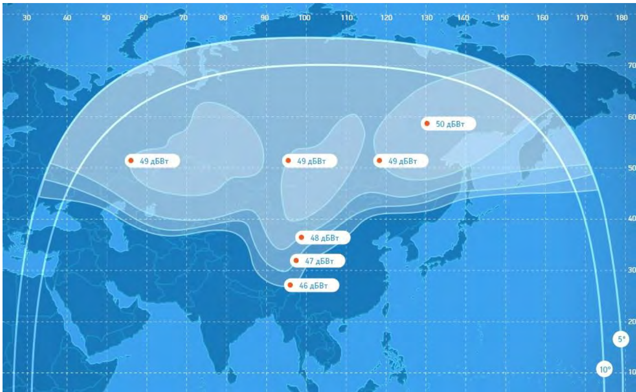
Рис. 4. ЭИИМ (дБВт) в рабочей зоне (фиксированный луч) ИСЗ ЭКСПРЕСС-АМЗ (103° в.д.) в Ku-диапазоне частот
