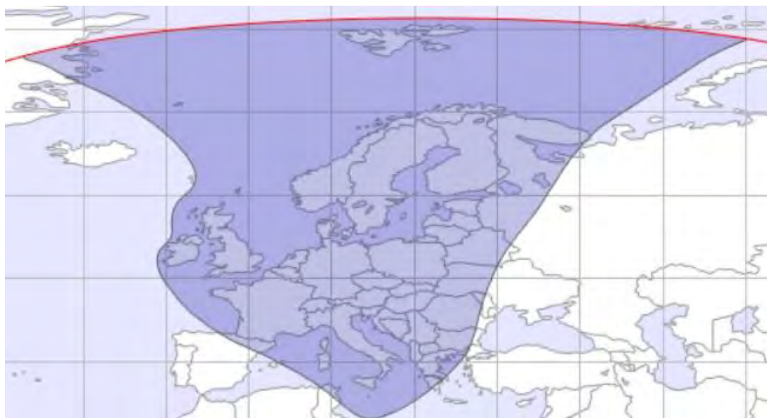
Рис. 1. Рабочая зона (Европа) ИСЗ GOVSAT-1 (SES-16) (21,5° в.д.) в Ка-диапазоне частот
