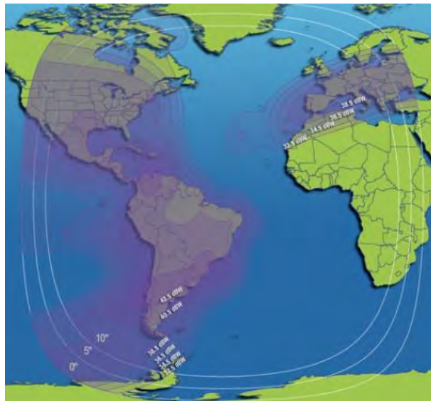
Рис. 66. ЭИИМ (дБ·Вт) в рабочих зонах ИСЗ INTELSAT-11 (43° з.д.) в C-диапазоне частот
