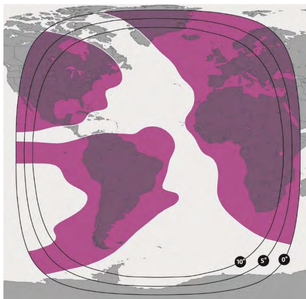
Рис. 25. Рабочие зоны ИСЗ NSS-10 (АМС-12, 37,4° з.д.) в С-диапазоне частот
