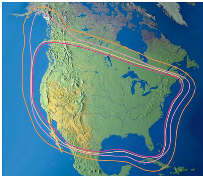
Рис. 60. Рабочая зона ИСЗ системы компании DirecTV в Ku-диапазоне частот (а) и в Ku-/Ka-диапазонах частот (б)
