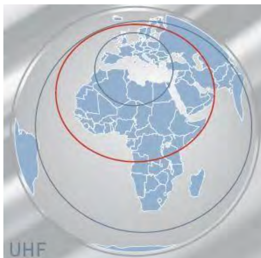
Рис. 1. Рабочие зоны ИСЗ SICRAL-1B (11,8° в.д.) в UHF-диапазоне частот
