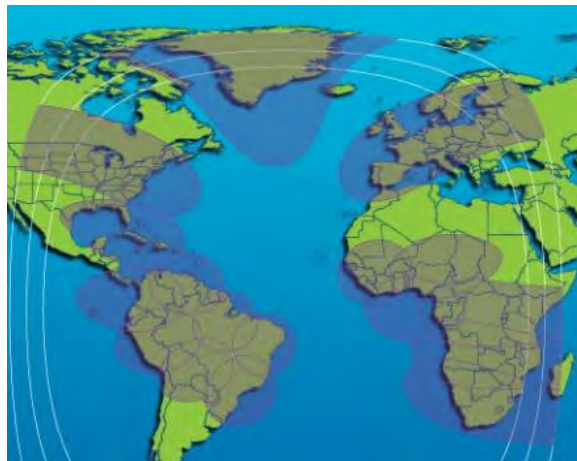
Рис. 111. ЭИИМ (дБ·Вт) в рабочих зонах (узкие лучи) ИСЗ INTELSAT-35e (34,5° з.д.) в C-диапазоне частот
