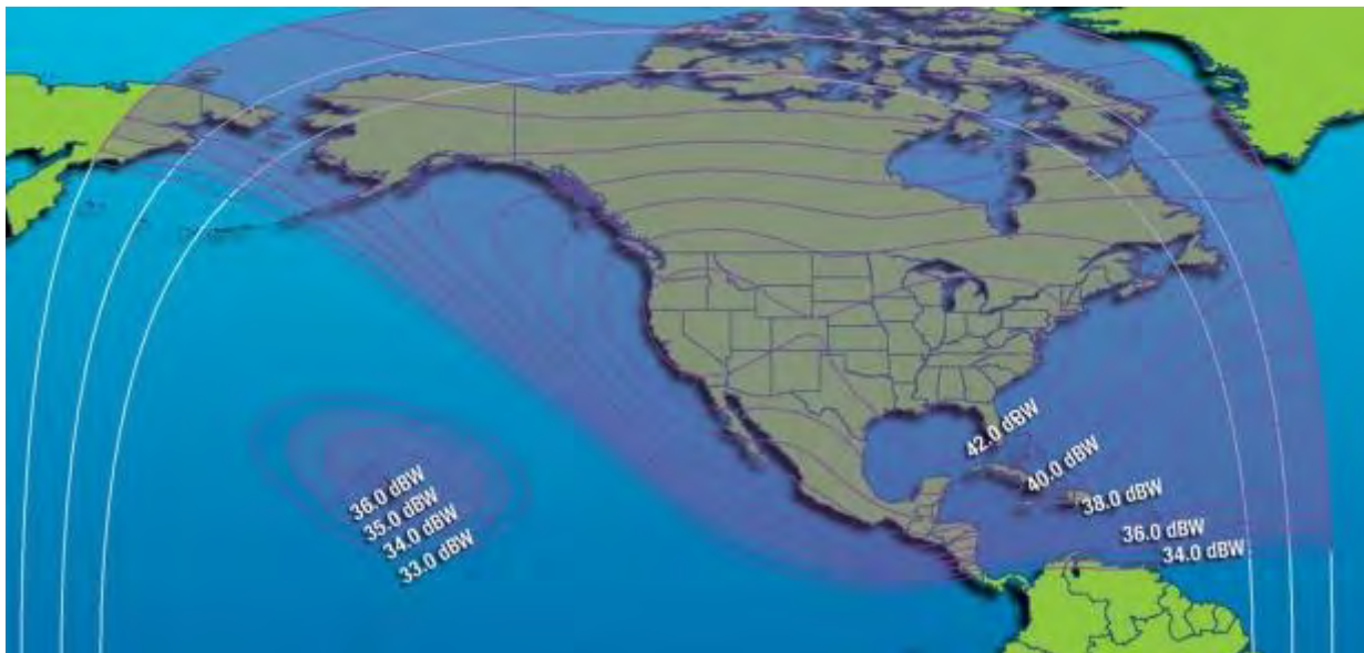
Рис. 47. ЭИИМ (дБ·Вт) в рабочих зонах ИСЗ GALAXY-23 (INTELSAT-A13, 121° з.д.) в С-диапазоне частот
