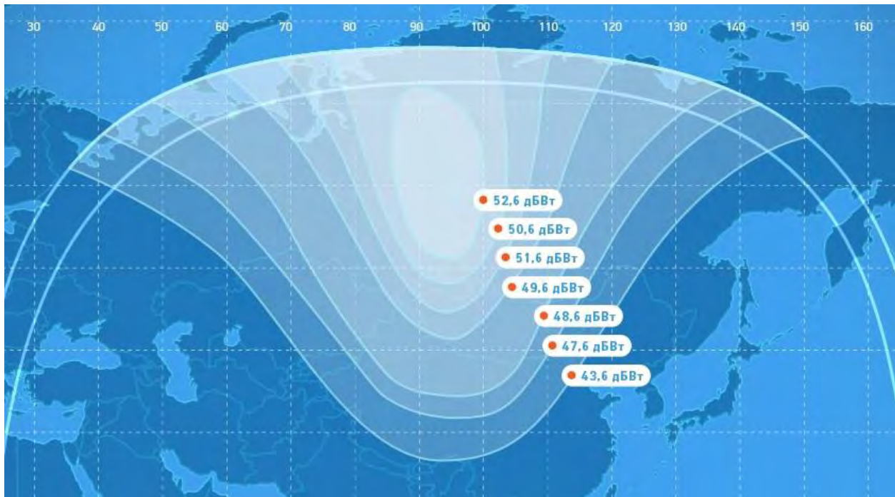
Рис. 11. ЭИИМ (дБВт) в рабочей зоне (2-й вариант перенацеливаемого луча) ИСЗ ЭКСПРЕСС-АМ33 (96,5° в.д.) в Ku-диапазоне частот
