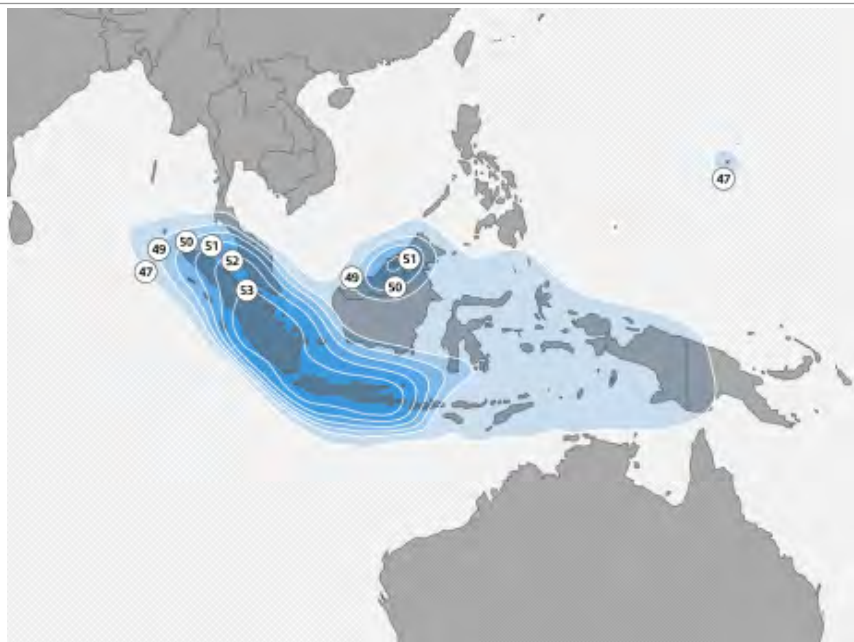
Рис. 110. ЭИИМ (дБ Вт) в рабочих зонах (Индонезия) ИСЗ SES-9 (108,2° в.д.) в Ки-диапазоне частот
