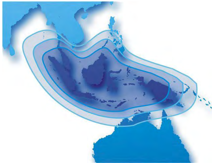
Рис. 20. Рабочие зоны ИСЗ PALAPA-D (113° в.д.) в Ku-диапазоне частот
