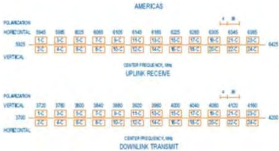
Рис. 3. Частотный план ретрансляторов ИСЗ INTELSAT-9 (PAS-9) в С-диапазоне частот
