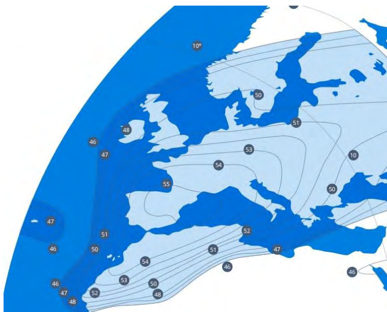
Рис. 15. ЭИИМ (дБ·Вт) в рабочих зонах (на Европу) ИСЗ HISPASAT-36W-1 (36° з.д.) в Ku-диапазоне частот
