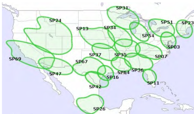
Рис. 94. Рабочие зоны ИСЗ ECHOSTAR-16 (61,5° з.д.) в Ku-диапазоне частот
