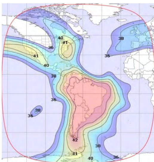
Рис. 56. ЭИИМ (дБ·Вт) в рабочих зонах ИСЗ EUTELSAT-65 West A (65° з.д.) в C-диапазоне частот
