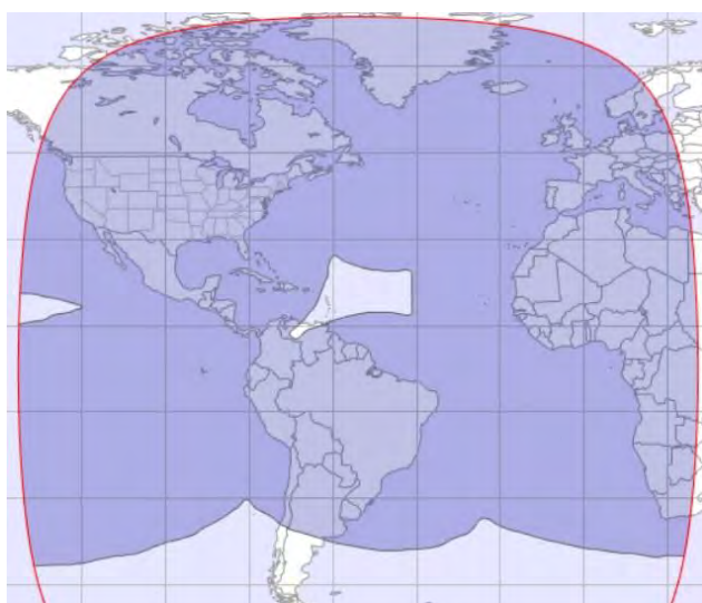
Рис. 4. Рабочие зоны ИСЗ INMARSAT-3F5 (54° з.д.) в L-диапазоне частот
