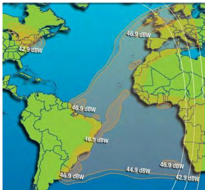
Рис. 97. ЭИИМ (дБ·Вт) в рабочих зонах (подвижные абоненты) ИСЗ INTELSAT-21 (58° з.д.) в Ku-диапазоне частот
