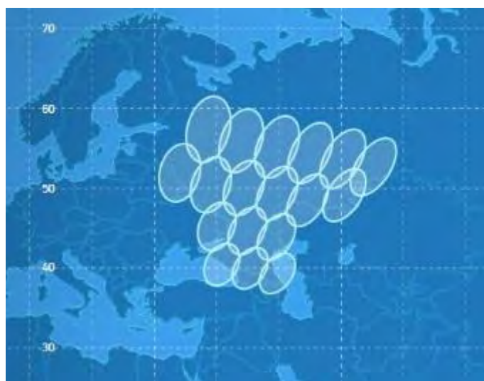
Рис. 54. ЭИИМ (дБ·Вт) в рабочей зоне (2-й фиксированный луч) ИСЗ ЭКСПРЕСС-АМУ-1 (36° в.д.) в Ku-диапазоне частот
