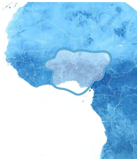
Рис. 40. Рабочие зоны ИСЗ HYLAS-3 (31° в.д.) в Ka-диапазоне частот
