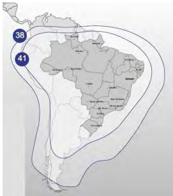
Рис. 16. ЭИИМ (дБ·Вт) в рабочей зоне (на Бразилию) ИСЗ STAR ONE-C3 (75° з.д.) в С-диапазоне частот
