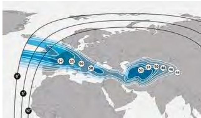
Рис. 104. ЭИИМ (дБ Вт) в рабочих зонах (восточная) ИСЗ MONACOSAT (52° в.д.) в Ku-диапазоне частот
