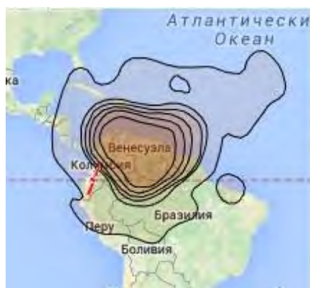
Рис. 6. Рабочие зоны (Венесуэла) ИСЗ VENESAT-1 (78° з.д.) в Ka-диапазоне частот
