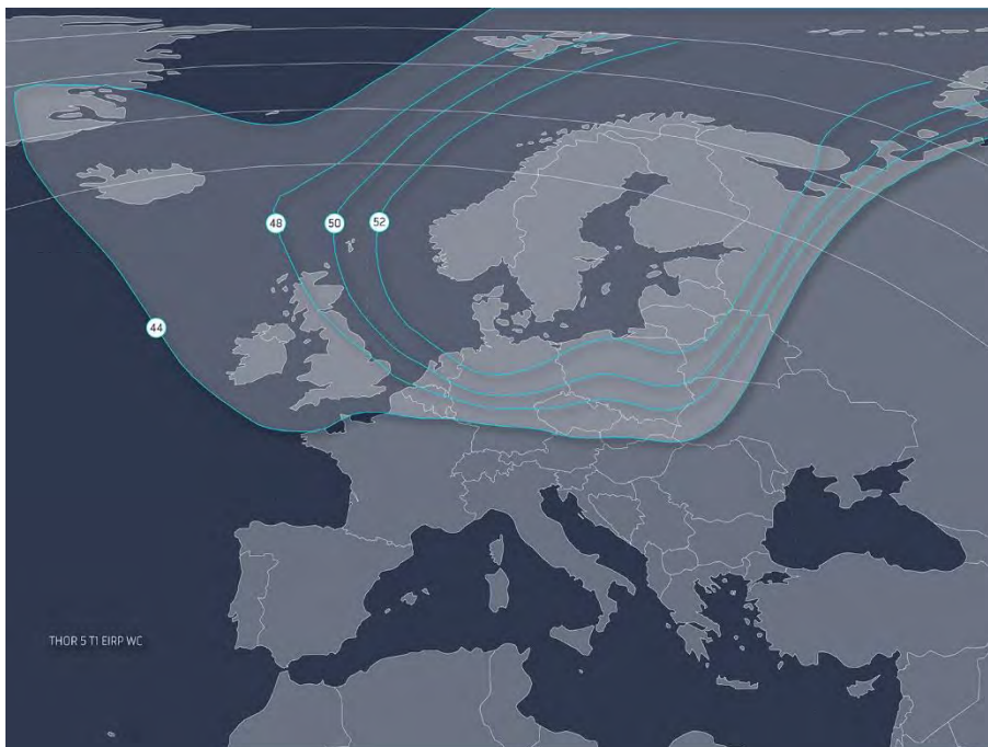
Рис. 3. ЭИИМ (дБ·Вт) в рабочих зонах (Т1) ИСЗ THOR-5 (0,7° з.д.) в Ku-диапазоне частот
