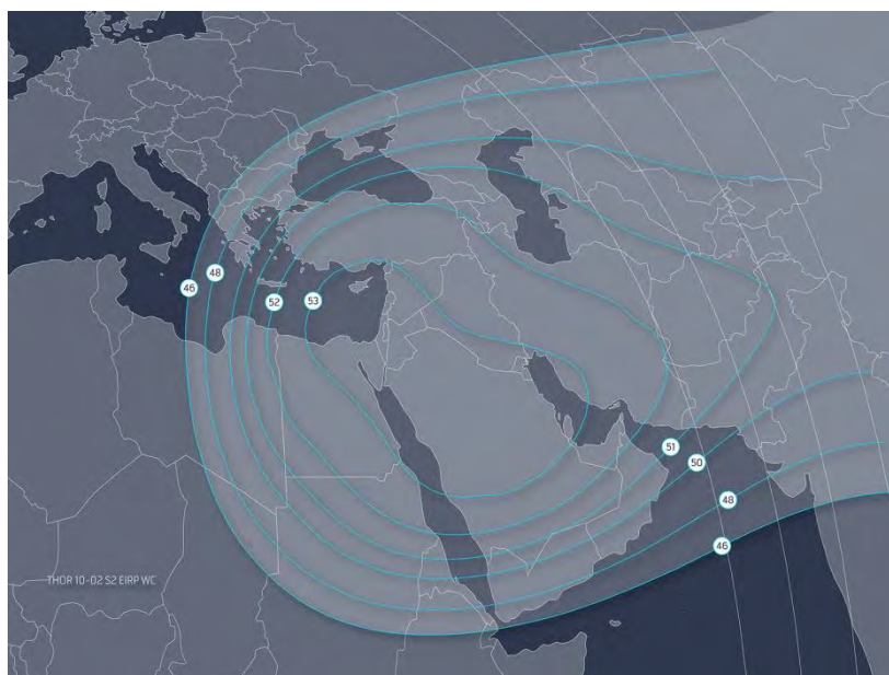
Рис. 2. ЭИИМ (дБ·Вт) в рабочих зонах (луч 2, горизонтальная поляризация) ИСЗ THOR-10-02 (INTELSAT-10-02) (1° з.д.) в Ku-диапазоне частот
