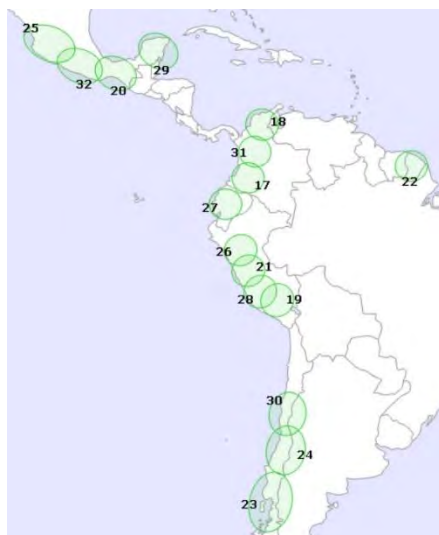
Рис. 63. ЭИИМ (дБ·Вт) в рабочих зонах (а – лучи на Бразилию, б – лучи на Мексику, Колумбию, Эквадор, Перу и Чили) ИСЗ EUTESAT-117 West B (116,8° з.д.) в Ka-диапазоне частот
