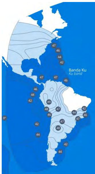
Рис. 22. ЭИИМ (дБ·Вт) в рабочих зонах ИСЗ HISPASAT-30W-6 (-1F) (30° з.д.) в Ку-диапазоне частот
