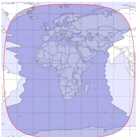
Рис. 8. Рабочие зоны ИСЗ INMARSAT-4AF4 (ALPHASAT) (24,9° в.д.) в L-диапазоне частот
