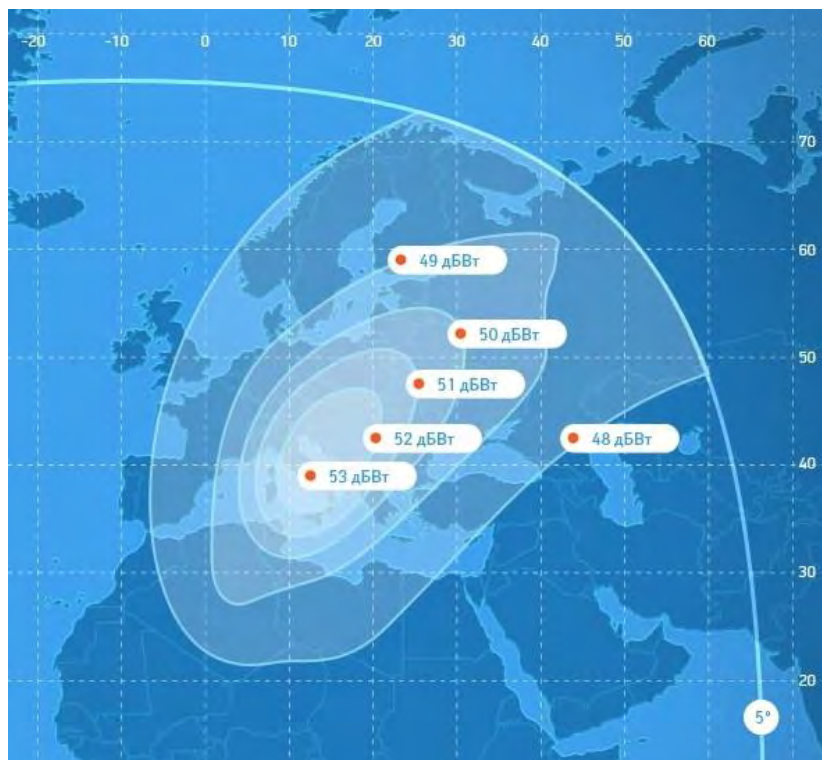
Рис. 13. ЭИИМ (дБВт) в рабочей зоне (1-й вариант перенацеливаемого луча) ИСЗ ЭКСПРЕСС-АМ44 (11° з.д.) в Ku-диапазоне частот
