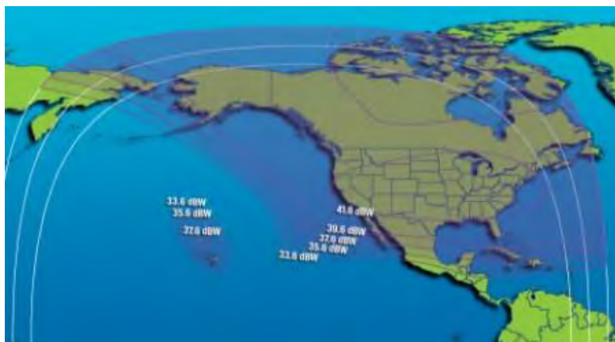
Рис. 62. ЭИИМ (дБВт) в рабочих зонах ИСЗ GALAXY-15 (133° з.д.) в С-диапазоне частот
