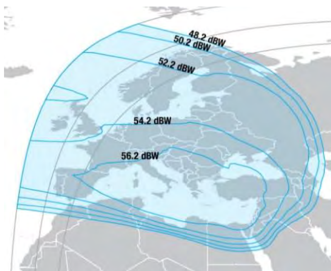
Рис. 124. ЭИИМ (дБ·Вт) в рабочих зонах (а – полуглобальный луч, б – на Европу, в – на Мозамбик, г – на Мьянму и д – на юго-восточную Азию) ИСЗ INTELSAT-39 (62° в.д.) в С-диапазоне частот
