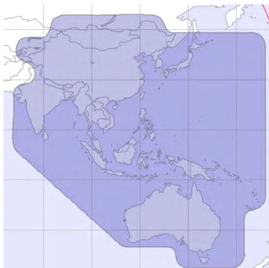
Рис. 44. Рабочие зоны ИСЗ THURAYA-3 (98,5° в.д.) в L-диапазоне частот
