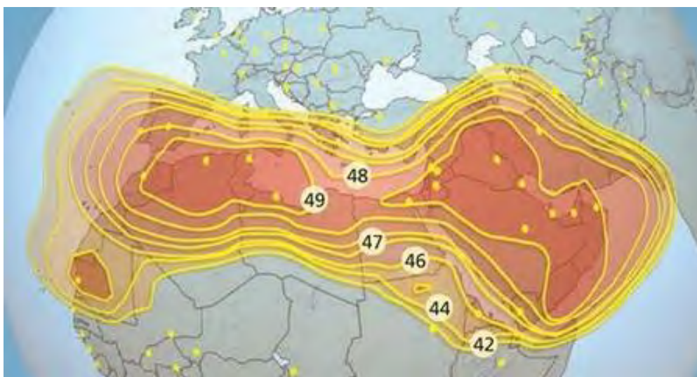
Рис. 38. Планирующаяся ЭИИМ (дБ·Вт) в рабочих зонах ИСЗ ARABSAT-6E (34,5° в.д.) в Ku-диапазоне частот
