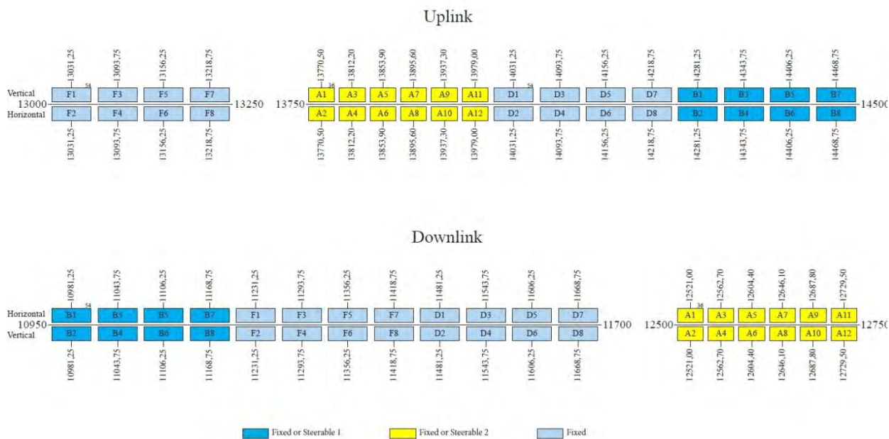
Рис. 16. Частотный план ретрансляторов ИСЗ ЭКСПРЕСС-AM5 в Ku-диапазоне частот
